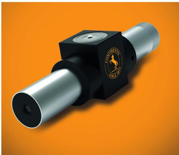
**CONTI® LASER ALIGNER** – это измерительный лазерный прибор для точного выставления шкивов ременных передач и звездочек цепных передач. Его отличает выгодная цена по сравнению с аналогичными устройствами на рынке. Данный прибор с помощью плоского лазера позволяет легко и быстро избавиться от горизонтального и вертикального углового отклонения осей, а также осевого смещения шкивов. Специальная подготовка персонала для применения CONTI® LASER ALIGNER не требуется.
