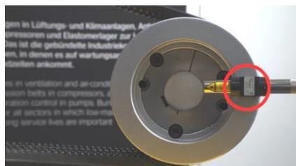
② Закрепите CONTI® Laser Aligner на боковой стороне противоположного шкива (при необходимости используйте магнитную пластину).
